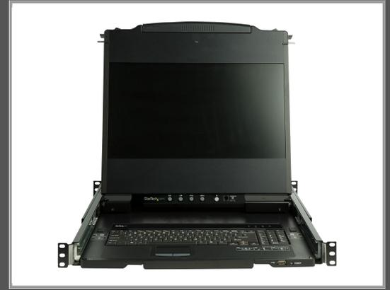
KVM-Konsole mit KVM-Switch - 1 Anschlüsse - USB - 43.9 cm (17.3") - Rack - einbaufähig - 1920 x 1080 Full HD (1080p) @ 60 Hz - 250 cd/m<sup>2</sup> - 650:1 - 8 ms - 2xDVI-D - 2xVGA - Schwarz - 1U
