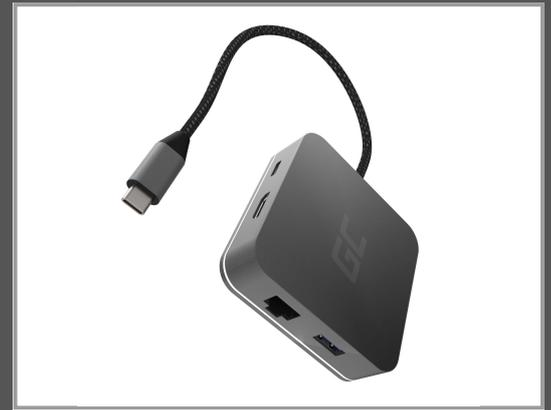
USB C - 3x USB A - HDMI - RJ-45 - 30x109x12.5 mm
